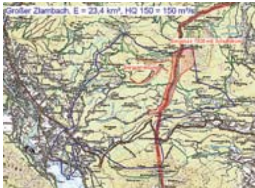
Abb. 4: Die stark aufgelockerten Oberlaufbereiche und die aktiven Hangbewegungen liefern große Mengen tonreiches und grobkörniges Material, dass im Falle von Starkregenereignissen zumindest teilweise mobilisiert werden kann. Der Unterlaufbereich im Ortsgebiet von Bad Goisern ist lediglich auf ca. 30-jährliche Ereignisse ausgebaut (Dammgerinne) und gefährdet daher den tiefer liegenden Siedlungsbereich sowie die vorhandenen Infrastruktureinrichtungen (B 145, Gemeindestraßen und ÖBB) durch mögliche Bachaustritte weitflächig.
