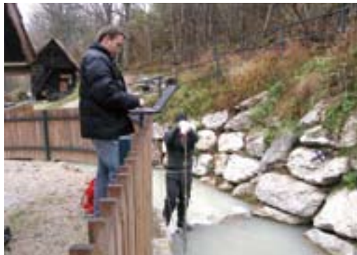
Abb. 21: Messung Gaflenzbach, FWH Katzensteinermühle; Strömungsgeschwindigkeit und -verteilung.
