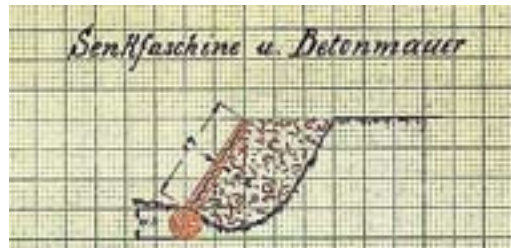
Abb. 4: Senkfascine und Betonmauer im Steinbach 1919. Gde. Steinbach am Ziehberg. Gbl. Salzkammergut.
