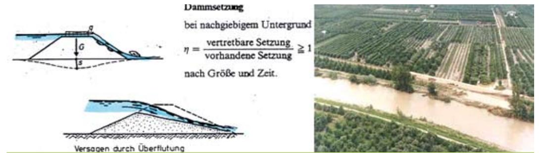
Abb. 6.1b: Hydraulisches Dammversagen – Ereignis Terlan 1987
