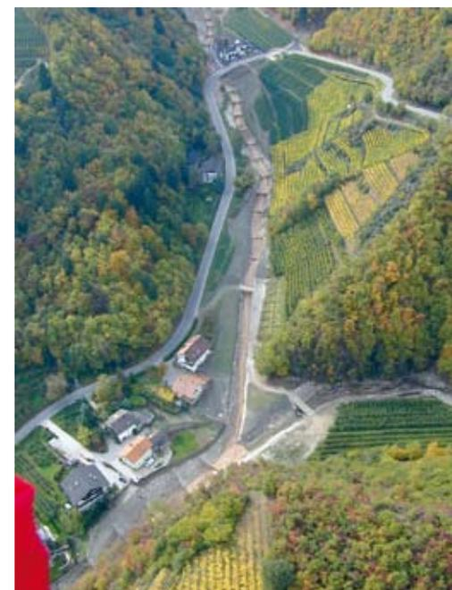
Abb. 21: Übersicht der Verbauungsmaßnahmen im Unterlauf des Grissianerbaches
