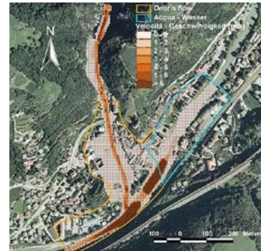
Abb. 4: Simulationsergebnisse - Geschwindigkeiten (D'Agostino et al., 2005)
