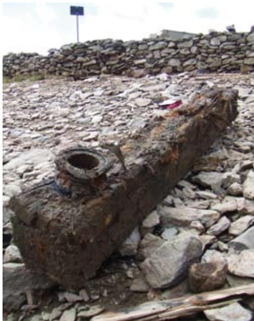
Abb. 6: Ursprüngliche Entnahmeleitung mit regulierbarer Öffnung
