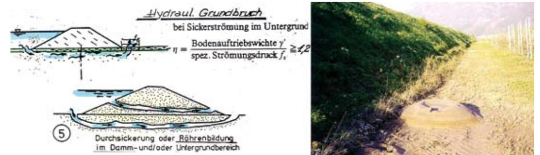
Abb. 6.1c: Hydraul. Grundbruch – Qualmtrichter am Dammfuß in Salurn
