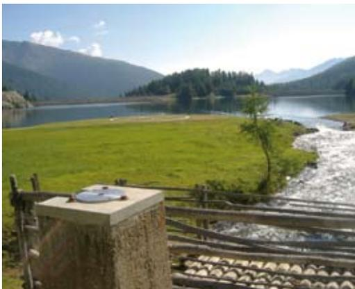
Abb. 17: Weißbrunner Stausee (Ultental): Fixpunkte zur topografischen Präzisionsvermessung.
