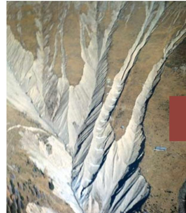
Abb. 3: Stark erodierte Gräben mit den soeben fertig gestellten Stahlbetonsperren. Rechts im Bild als Größenvergleich die 25 m lange Bauhütte
