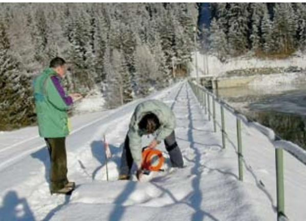
Abb. 2: Messung der Wasserstände in den Piezometern in einem Erddamm (Sexten im Pustertal).
