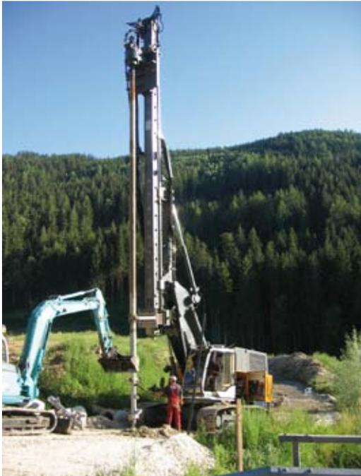
Abb. 5: Soilcrete-M-Gerät mit Einfachpaddel
