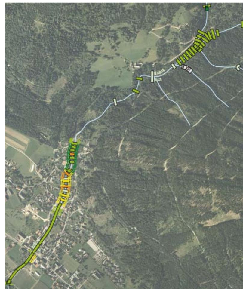
Abb. 6: Darstellung des Erhaltungszustandes im GIS (der verwendete Farbcode zur Darstellung ist gleich wie oben angegeben)
