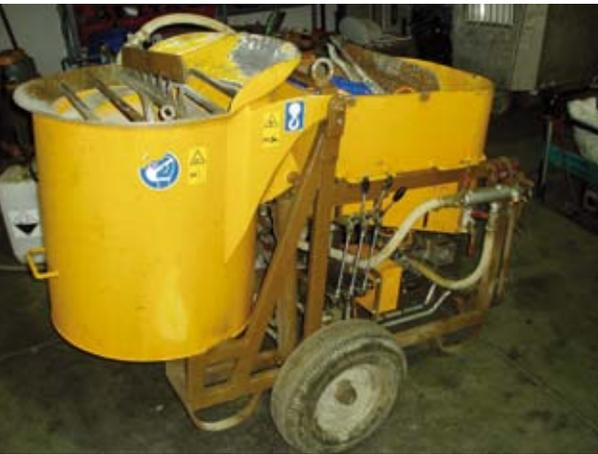
Abb. 5: Ankermörtelpumpe mit hydr. Antrieb
