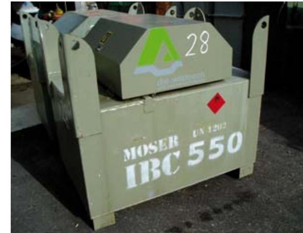
Abb. 9: Treibstofftank: Gesamtgewicht von 900kg
