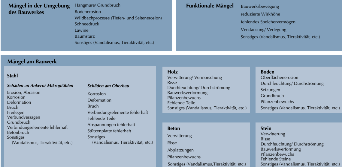
Abb. 8: Schema Mängel an Lawinenwerken
