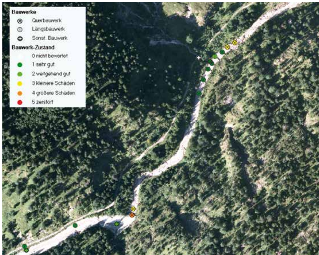
Abb. 3: Darstellung der Bauwerke und des baulichen Zustands
