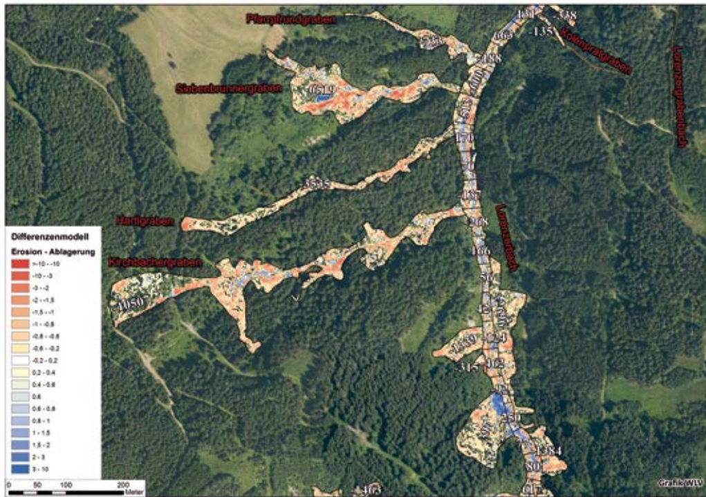
Abb 5: Geschiebebilanzierung aus dem Differenzenmodell in m³ [Rot: negative Werte = Erosion; Blau: positive Werte = Ablagerung]
