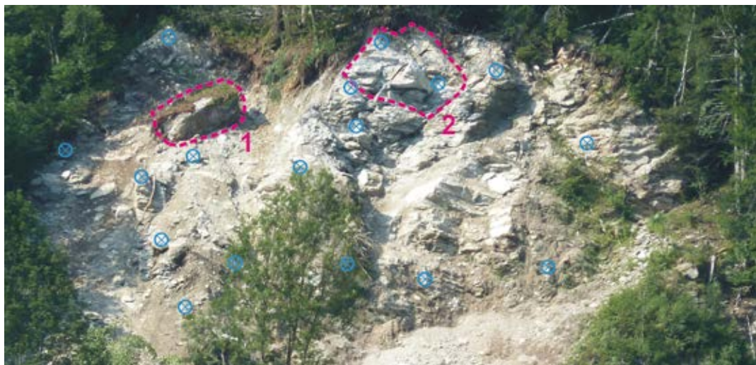
Abb. 2: Detailansicht des Abbruchbereichs; 1...Großblock, entfernt mittels Sprengung am 24.07.2012; 2...Felsbereich, der am 26.07.2012 versagte. Blaue Kreise...Position der geodätischen Messpunkte (Bildbreite rd. 55 m).
