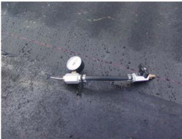
Abb. 5: Luftdruckprüfung der Doppelnah (© Tschernutter)
