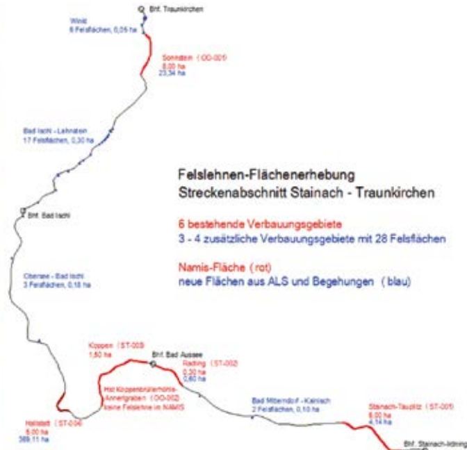
Abb. 3: Erhebung der Lehnflächen am Beispiel des 84,5 km langen Streckenabschnitts Traunkirchen-Stainach/Irdning. (rot) bestehende Lehnflächen (NAMIS), (blau) neu hinzugekommene Lehnflächen.
