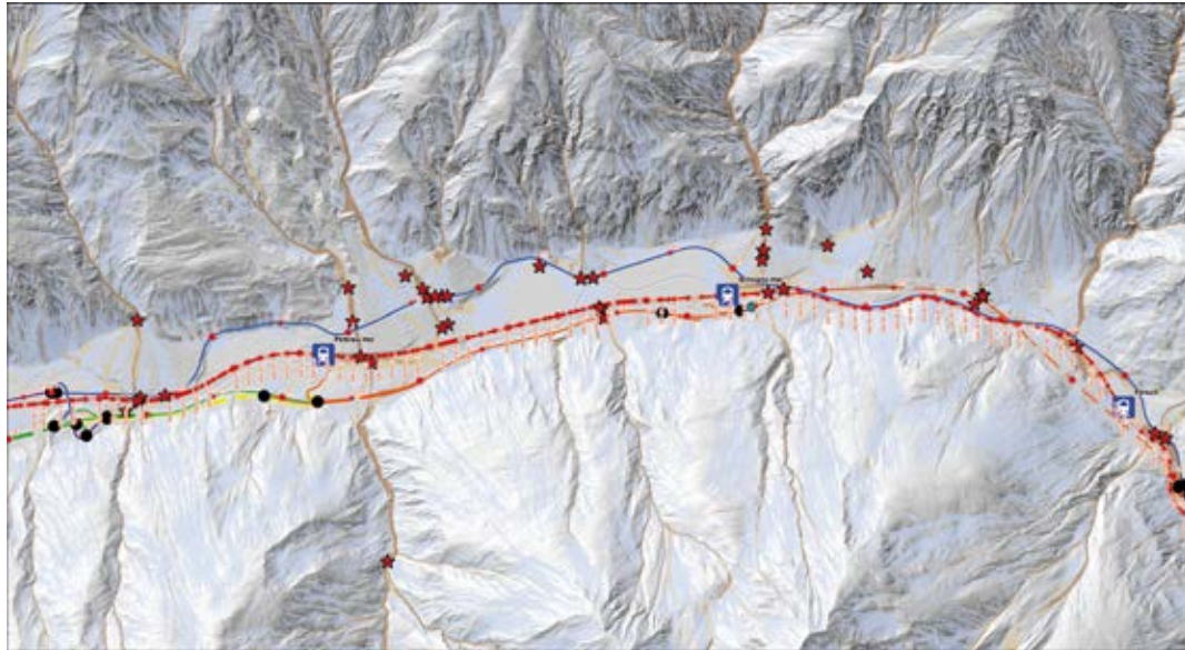
Abb. 16: Regionale Mureinwirkungsanalyse für ein mittleres Szenario für potenziellen Murabfluss im Stanzertal (Sterne in der Karte stehen für dokumentierte Mureignisse).
