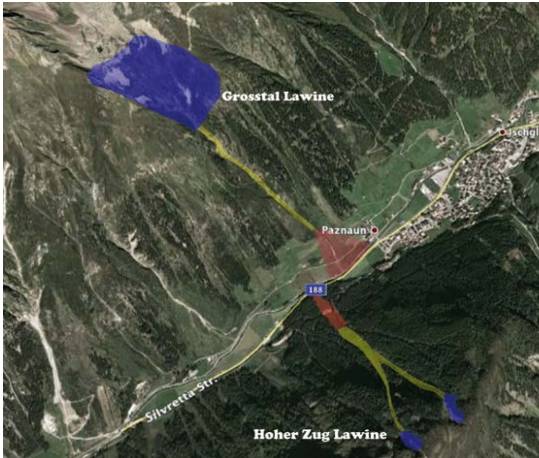
Abb. 1: Überblick Lawinenzüge Großtal und Hoher Zug. Anbruchgebiet (blau), Sturzbahn (gelb) und Ablagerungsbereich (rot) sind markiert. Die gefährdete Silvretta-Straße B188 sowie die Ortschaft Ischgl sind gekennzeichnet. (Quelle Foto: Google Earth©).
