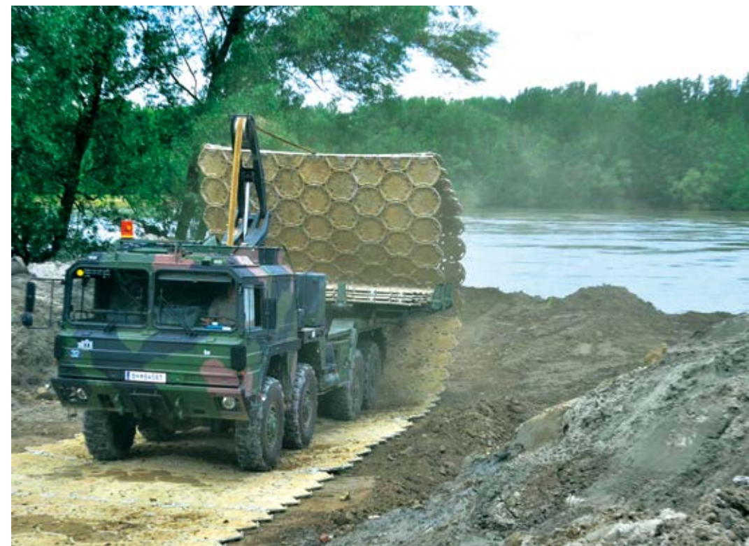
Abb. 5: Faltstraße im Hochwassereinsatz 2013 (Foto: Bundesheer/ Severin Ganglberger)
