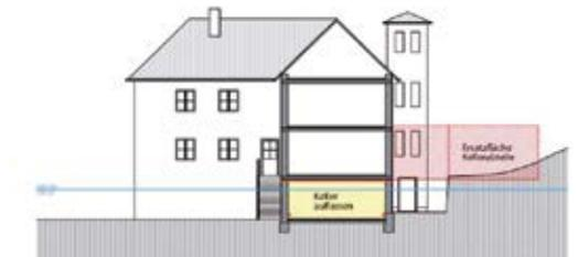
Abb. 8: Höherlegung von Gebäudeteilen (© Ingenos.Gobiet.ZT GmbH)
