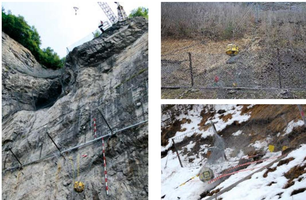
Abb. 2: Vertikalwurfanlage in Walenstadt (CH) (links) und Schrägwurfanlage in Lungern mit Schrägeiseilbahnlösung und Laufkatze (rechts), Quelle Pfeifer Isofer Schweiz.
