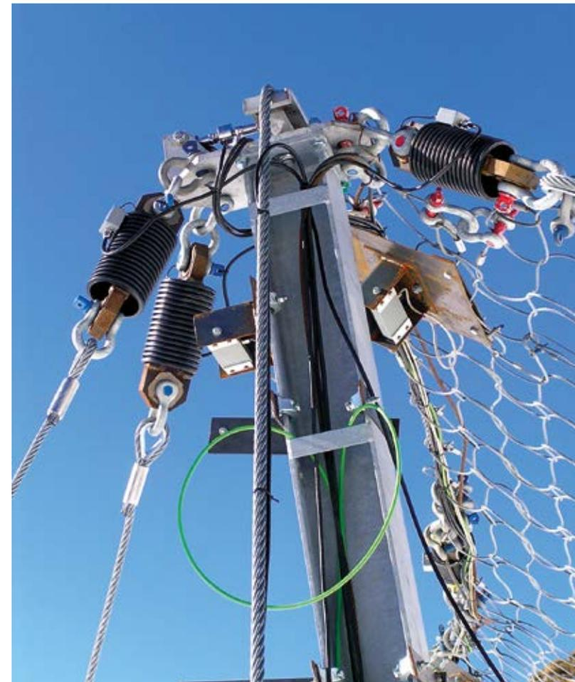
Abb. 14: Instrumentiertes Schneenet auf dem Hafelekar zur Ermittlung von auftretenden Kräften
