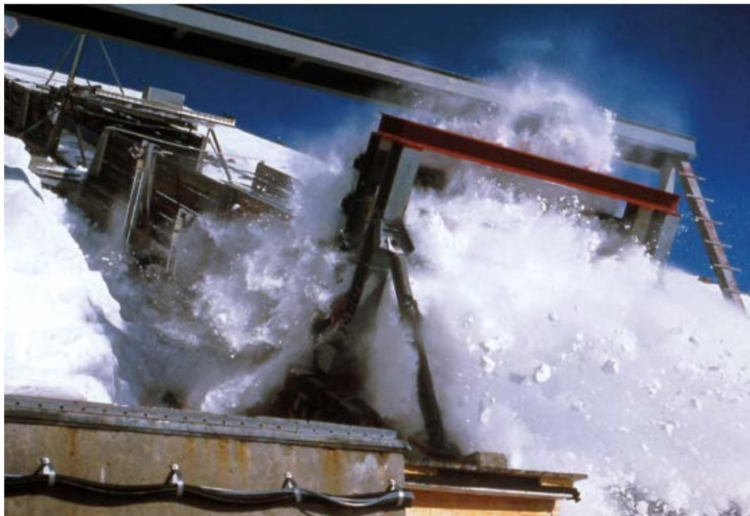
Abb. 3: Im Winter 1984/85 wurden auf der Gleitbahn auf dem Weissfluhjoch Versuche durchgeführt, um den optimalen Rostbalkenabstand bei Schneerechen und -brücken zu untersuchen. Bei Schneebrücken ergab sich ein idealer Abstand zwischen den Rostbalken von 250 mm. Die Resultate wurden in der Technischen Richtlinie von 1990 berücksichtigt.
