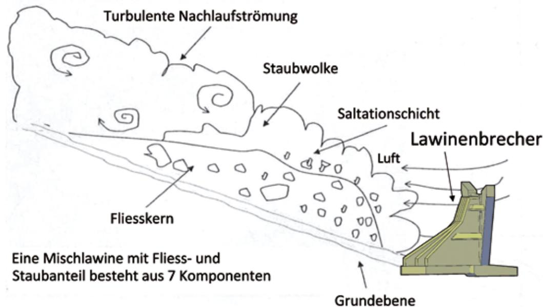
Abb. 3: Die Disposition des Lawinenbrechers gegenüber dem Prozess und seine Wirkung
