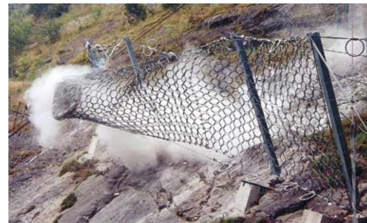
Abb. 1: Erste Schrägwurfanlage in der Schweiz in Beckenried, schematisch und in Aktion mit einem Steinschlagschutznetztest
