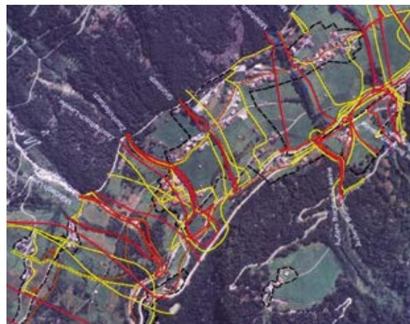
Abb. 3 Beispiel Gefahrenzonenuntersuchung und -ausweisung Lawinen, Lawine Schoberboden, Steiermark (Quellen: WLW Tirol)
