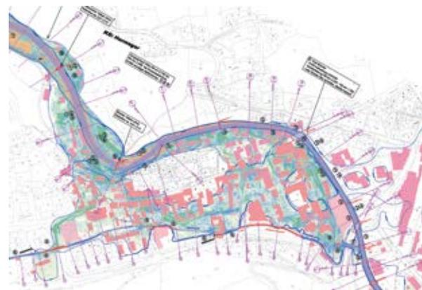
Abb. 2: Beispiel Gefahrenzonenuntersuchung durch Hochwasser in dicht besiedeltem Raum, mögliches Spannungsfeld Raumplanung – Hochwasserschutz (Quelle: Tschernutter und Land Salzburg)
