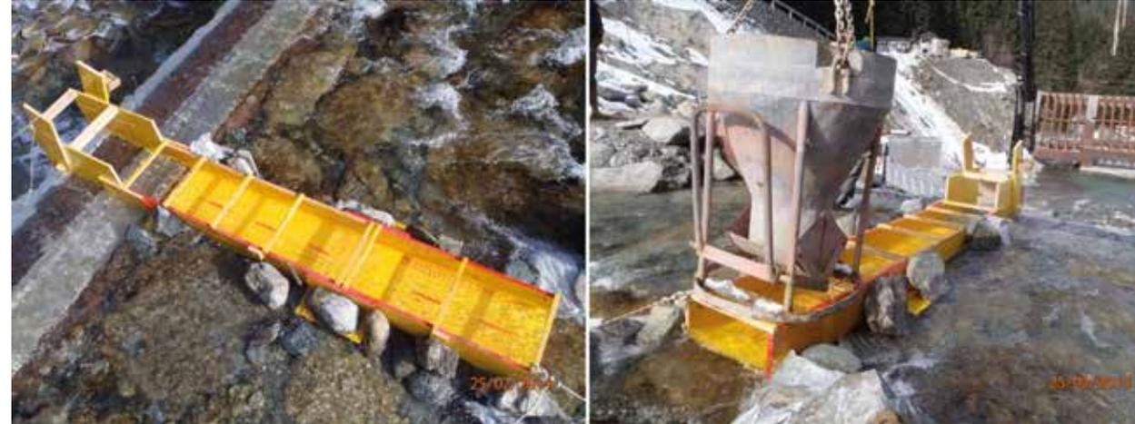
Abb. 4: Versuchsrinne: Links Draufsicht, rechts Versuchsrinne mit Geschiebezugabeeinrichtung.
