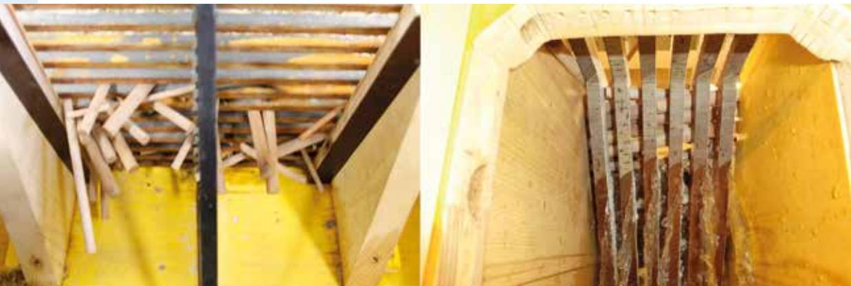
Abb. 10: Verschiedene Anlagerung des Wildholzes: links Balkensperre, rechts Rückseite der Rechensperre
