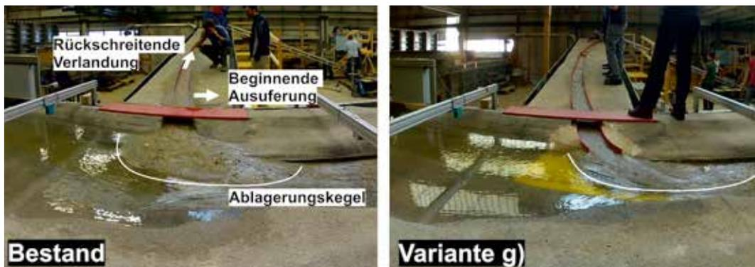
Abb. 7: Zeitgleicher Zustand während der Modellierung des Ereignisses „08/2005“ für den Bestand und die Variante (g)
