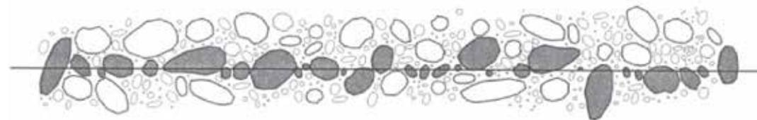
Abb. 2: Aufspannen einer zur Fließrichtung parallelen Linie und Erfassung der B-Achsen aller Körner unter der Linie mit Durchmessern größer 1-2cm (aus: Vorlesungsskript Flussbau, ETZ, 2004)
