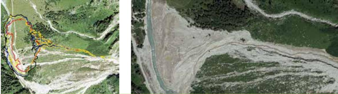
Abb. 7: (links) Beispiel der Simulationsergebnisse. Schwarze Umrandung: Szenario ohne Erosion, blaue Umrandung: Szenario mit Erosion (Dreipunkt-Ganglinie; ein Schub), gelbe Umrandung: „multiple surge simulation“ mit Variation der Voellmy Parameter, rote Umrandung: „multiple surge simulation“ ohne Variation der Parameter; (rechts) Ausschnitt aus dem Orthophoto 2015, ein Jahr nach dem Ereignis.
