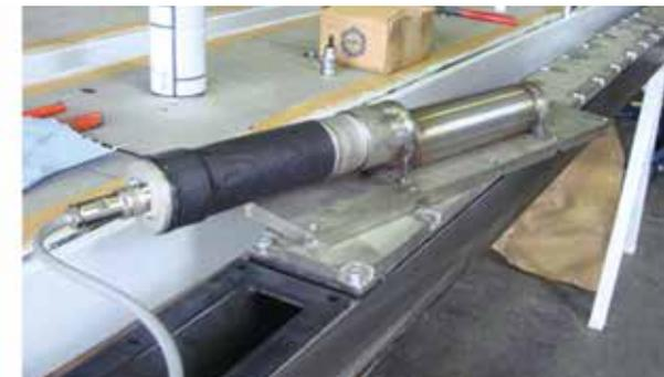
Abb. 1: Hydrophonmessplatte (rechts mit angeschlossenen Sensor).
