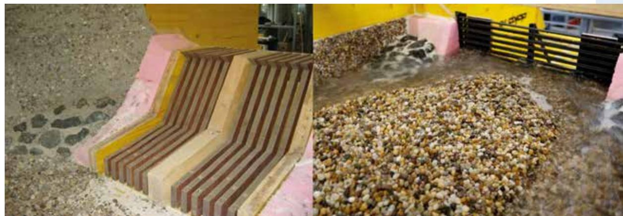
Abb. 2: Fotos der Rechensperre mit schrägem Anlaufteil (links) und Balkensperre (rechts)
