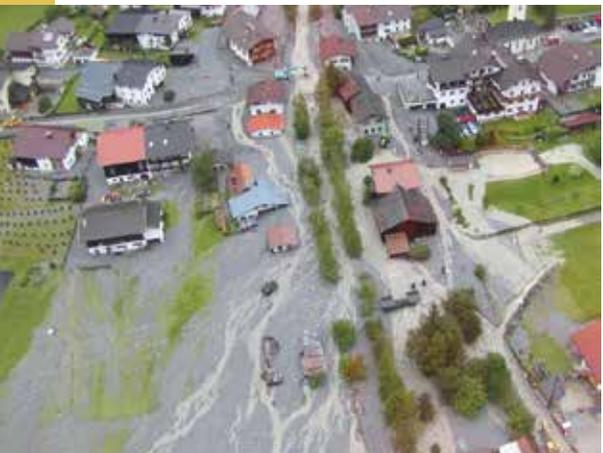
Abb. 3: Geschiebeablagerung am Schwemmkegel des Schnannerbaches, nachdem der Geschiebeeintrag in den Vorfluter auf Grund von Hochwasser in der Sanna nicht mehr möglich war.
