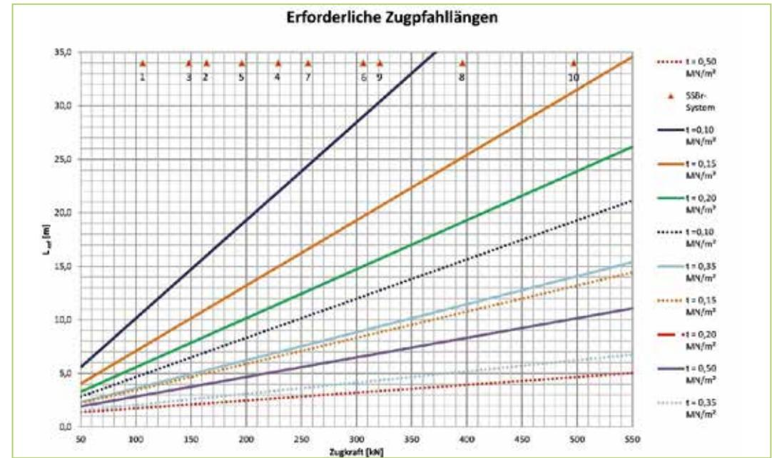
Abb. 6: Erforderliche Zugpfahllängen ( $L_{eff}$ ) in Abhängigkeit von der Mantelreibung ( $\tau_j$ ). Die durchgehenden Linien ergeben sich mit und die punktierten ohne Berücksichtigung des Modellfaktors  $\eta_{p,t}$ . Die Mikropfahlzugkräfte der Systeme 1 bis 10 für  $\psi = 45^\circ$  sind als rote Dreiecke am oberen Rand dargestellt.
