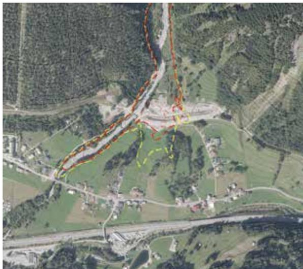
Abb. 4: Darstellung des Fließanteils der Lawinensimulation ohne Schutzmaßnahmen (links) und mit reduziertem Anbruchvolumen (rechts).
