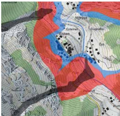
Abb. 7: Lawinengefahrenkarte von Eisten, Wallis, mit den im Januar 2018 aufgetretenen Lawinenabgängen (als schwarze Flächen dargestellt).
