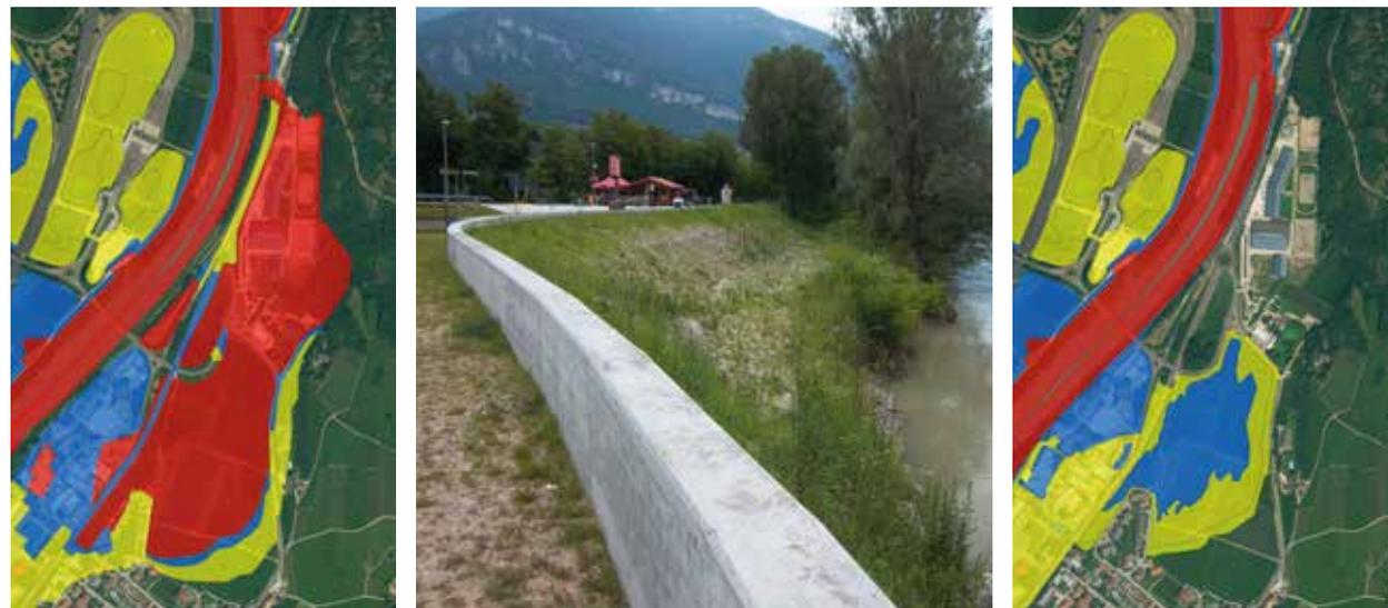
Abb. 5: Abänderung der Gefahrenzonen infolge der Errichtung einer Ufermauer
