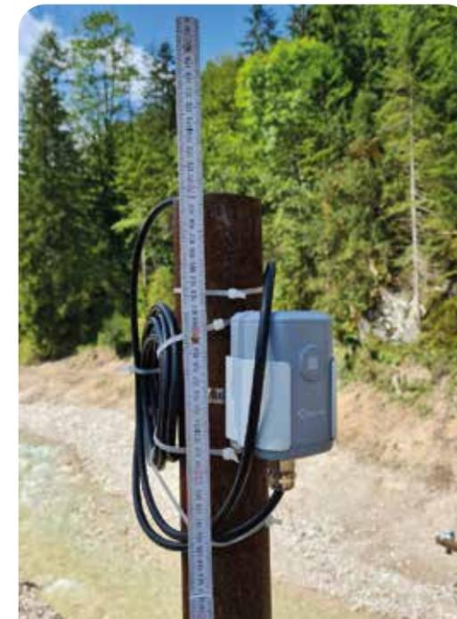
Abbildung 8: Drucksensor S03 montiert an der Klausenmauer
