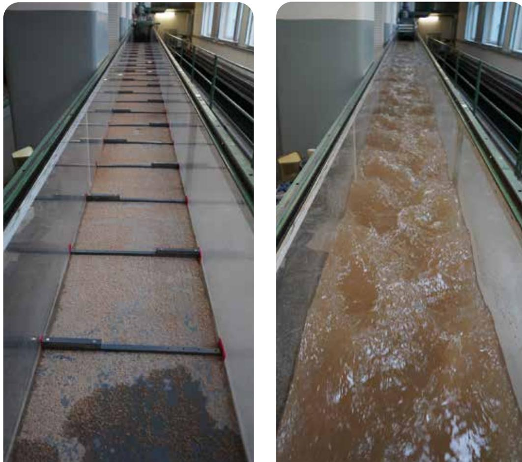
Abbildung 3: Ergänzende Versuchsreihe mit fester Sohle ( $L_{BF} = 0,75$  und  $1 \cdot B_F$  bzw.  $L_B = 1/3 \cdot B_F$ ) (Fotos: BAW 2021)
