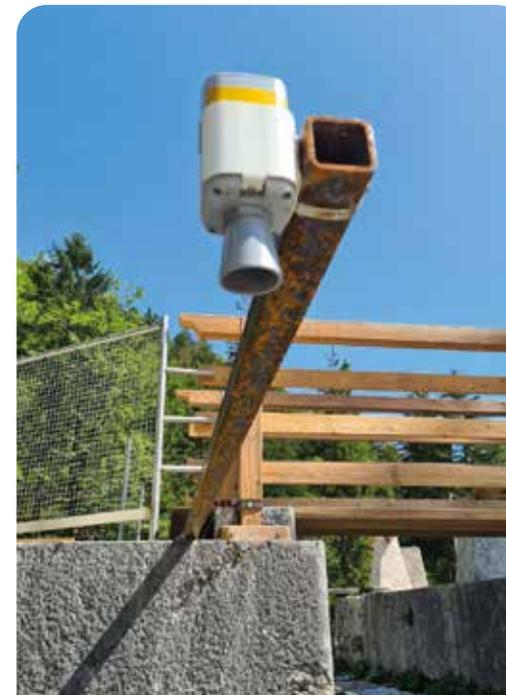
Abbildung 7: Ultraschallsensor S02 montiert an der Klausenmauer
