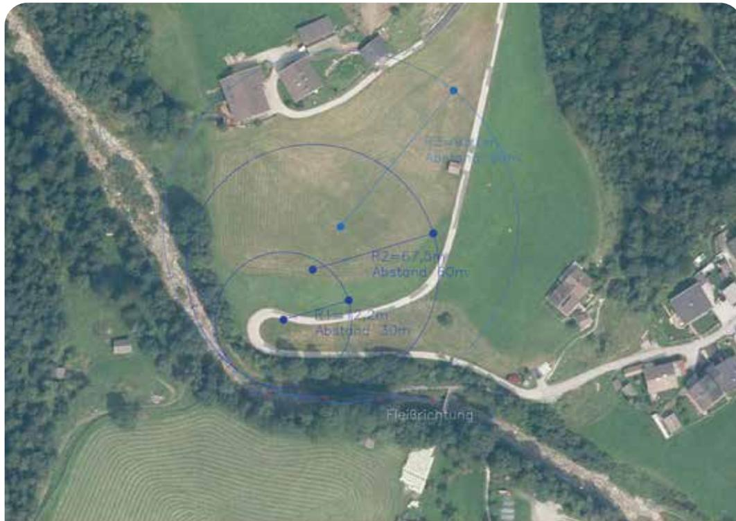
Abbildung 3: Übersicht des Gerinneabschnittes am Beispiel Nothdorfergraben für die Auswertung der Kurvenüberhöhung. Die Bestimmung der Kurvenradien basieren auf dem 3-Punktverfahren nach PROCHASKA et al. (2008).
