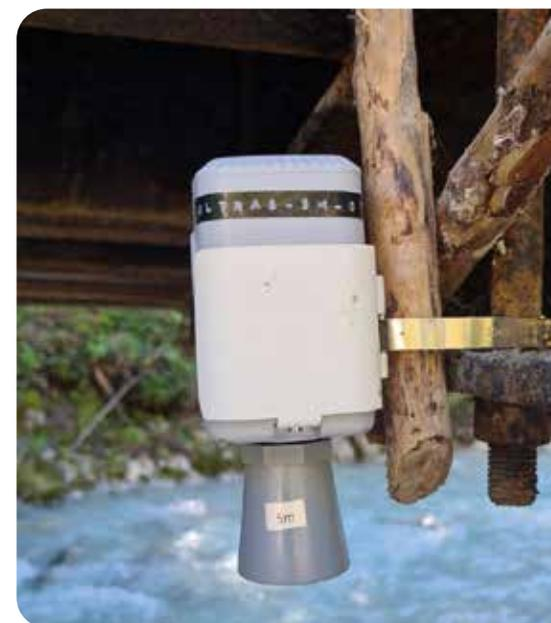
Abbildung 9: Ultraschallsensor S04 montiert bei der 1. Brücke im Weißenbachtal
