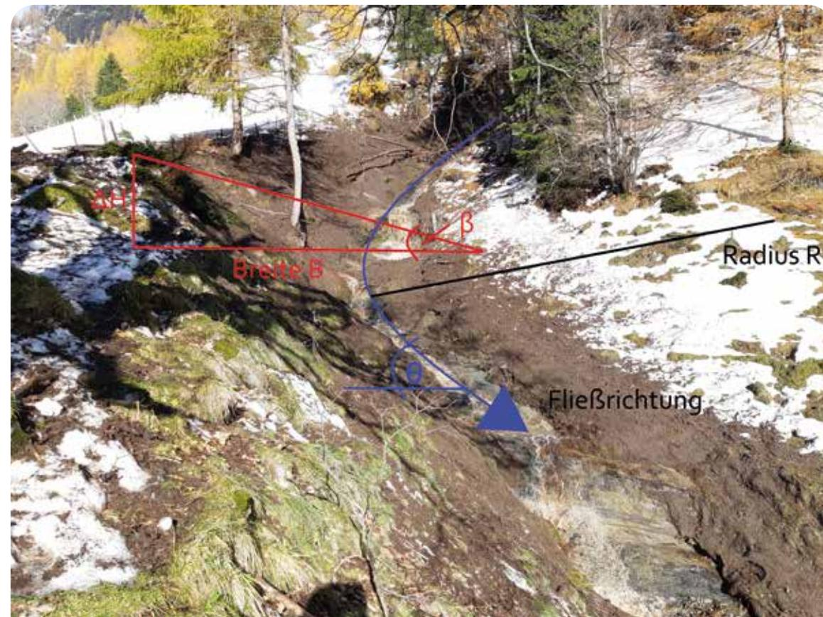
Abbildung 2: Darstellung der Eingangsparameter der „forced-vortex“ Gleichung am Beispiel Ofnergraben (Gem. Muhr); (B)... Fließbreite, R...Radius,  $\theta$ ...Gerinneneigung,  $\beta$ ...Überhöhungswinkel,  $g$ ...Erdbeschleunigung;
