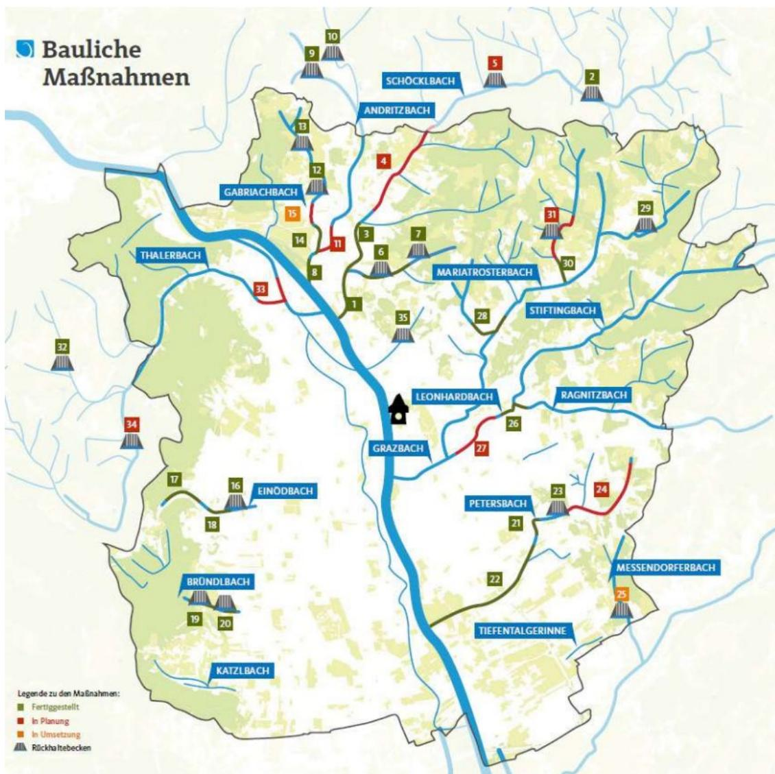
Abbildung 2: Übersicht der bereits fertiggestellten, in Umsetzung befindlichen und noch geplanten Hochwasserschutzmaßnahmen für die Stadt Graz.
